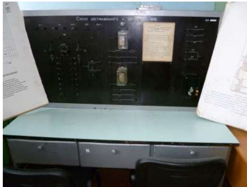
Рис.11. Зовнішній вигляд лабораторного стенду №7 з демонстративними матеріалами для вивчення принципів режиму роботи приводів високовольтних вимикачів
