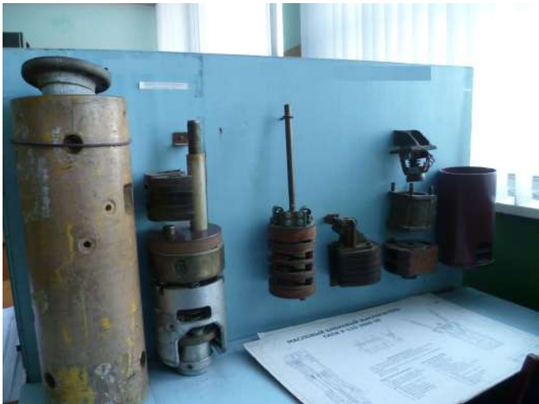
Рис.5. Зовнішній вигляд лабораторного стану №3.2 з демонстративними матеріалами для вивчення дугогасної камери великооб'ємних масляних вимикачів напругою 110 кВ
