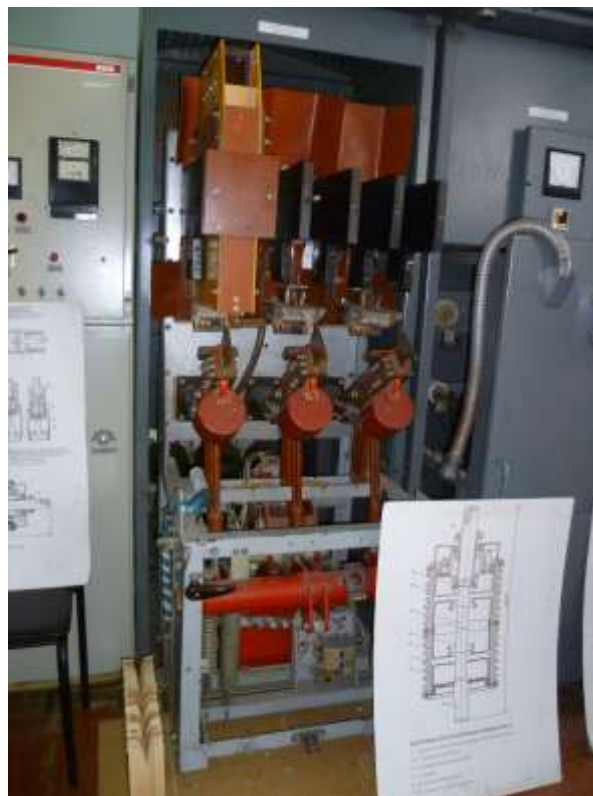
Рис.8. Зовнішній вигляд лабораторного стенду №4.1 з демонстративними матеріалами для вивчення конструкції дугогасної камери електромагнітних високовольтних вимикачів 10 кВ
