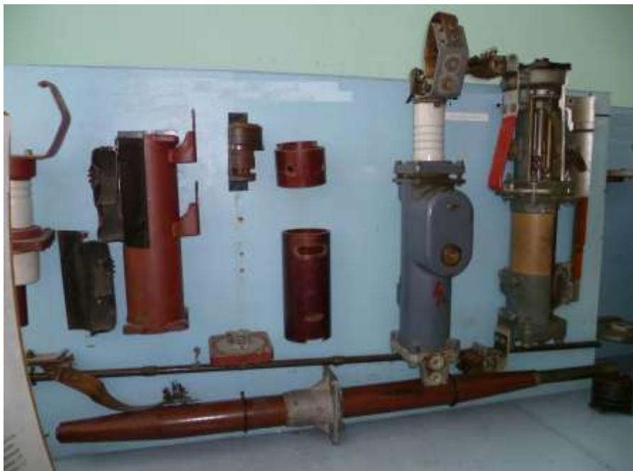
Рис.4. Зовнішній вигляд лабораторного стенду №3.1 з демонстративними матеріалами для вивчення конструкції дугогасної камери малооб'ємних масляних вимикачів напругою 6(10) кВ
