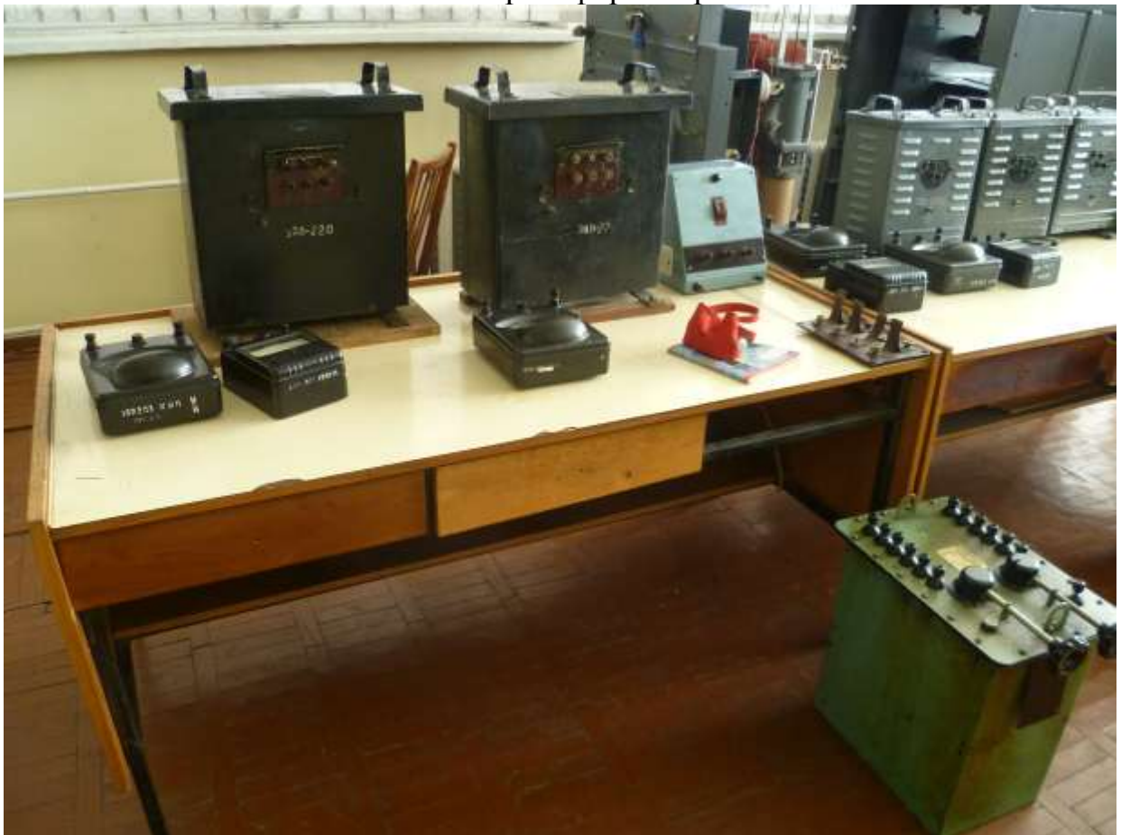
Рис.1. Зовнішній вигляд лабораторного стенду №1 для визначення реактивних опорів трифазних двохобмоткових трансформаторів 380/220 В
