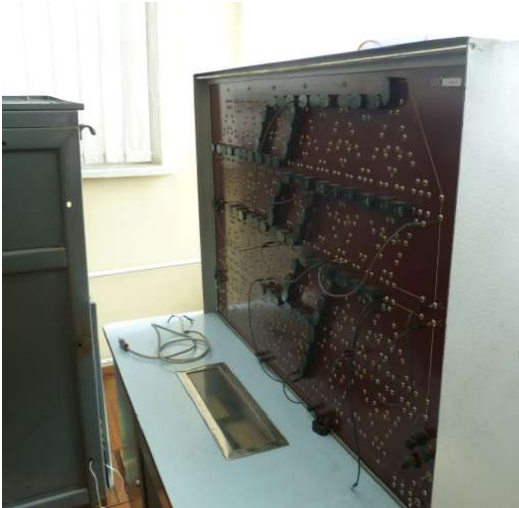
Рис.4. Зовнішній вигляд лабораторного стенду №4 з визначення параметрів комплексної схеми заміщення найпростішої схеми моделі електроенергетичної системи постійного струму
